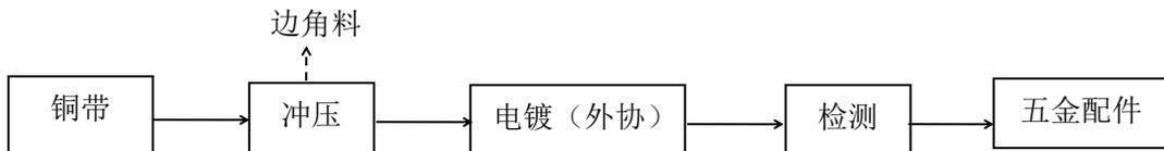
图 2-3 自制塑料配件、五金配件生产工艺流程图
