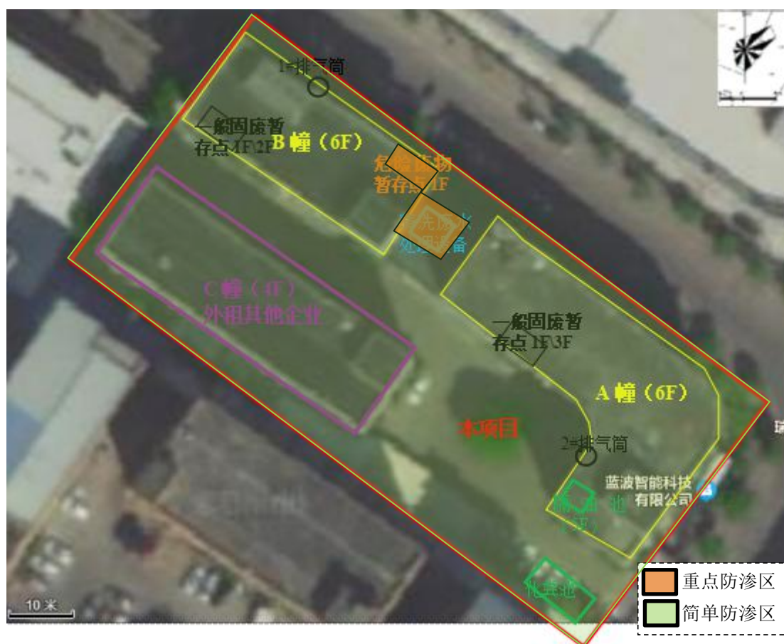
图 4-1 项目厂区地下水污染防治分区图
