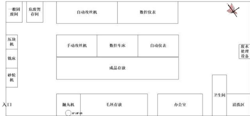
图 2-2 生产车间平面图
