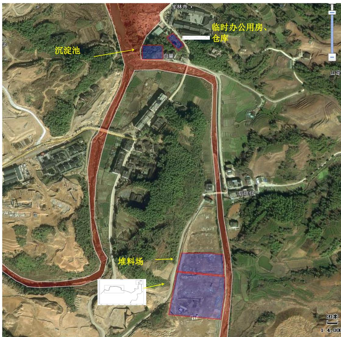
图 2-5 施工现场布置图
