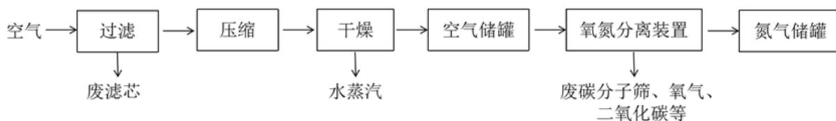
图 2-7 氮气制备工艺流程及产污节点图
