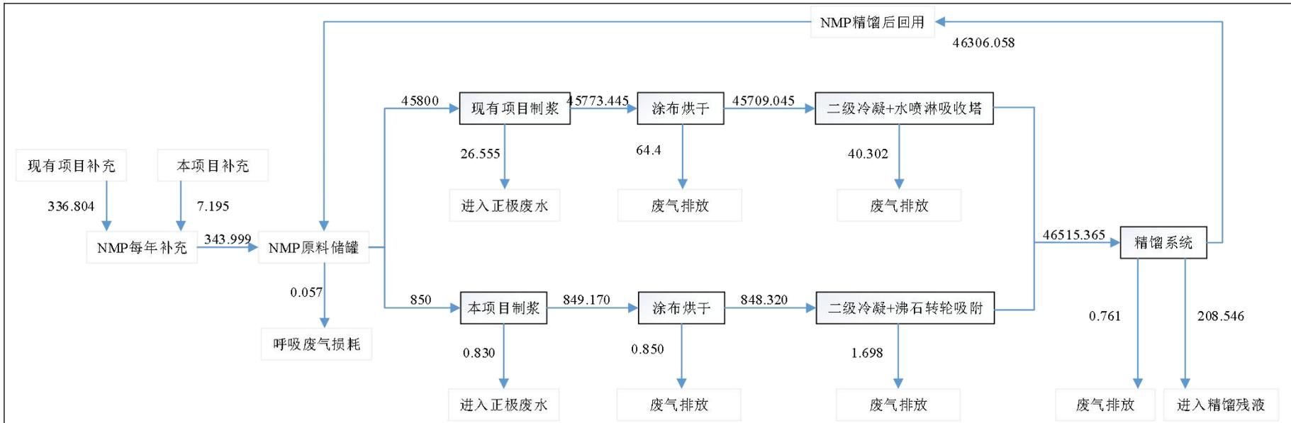
图 2-1 本项目实施后全厂 NMP 平衡图 单位：t/a
