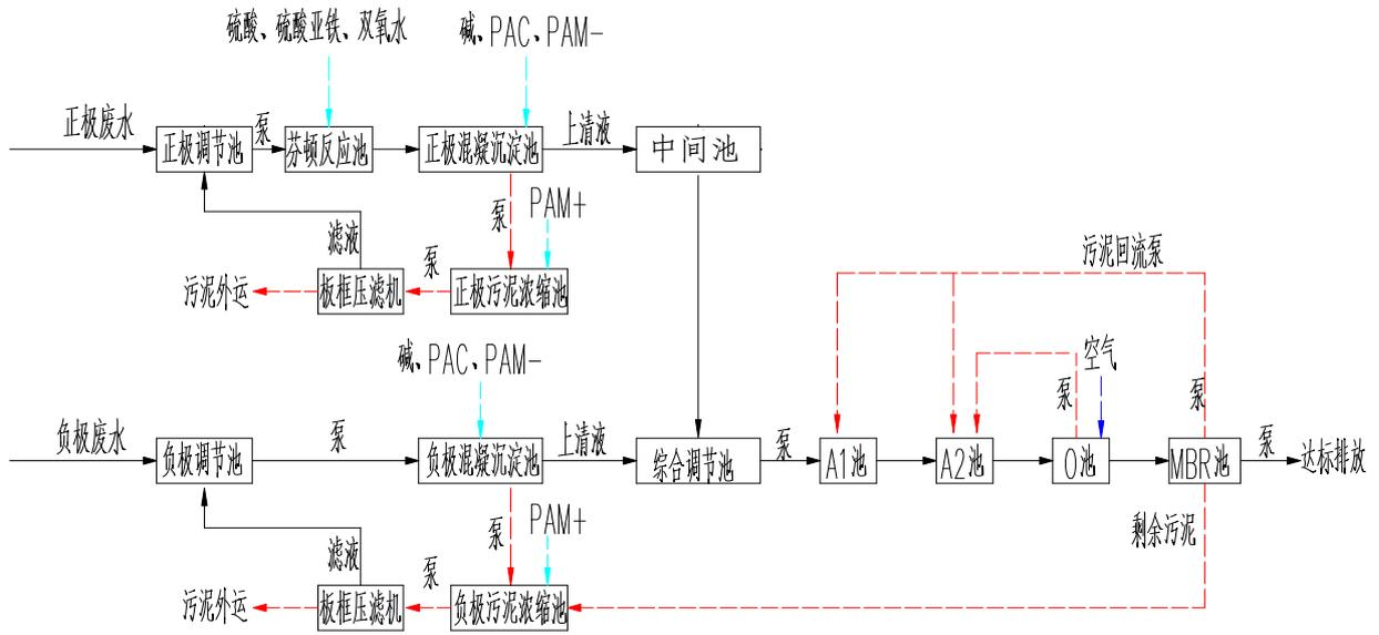
图 4-1 生产废水处理站处理工艺流程图
