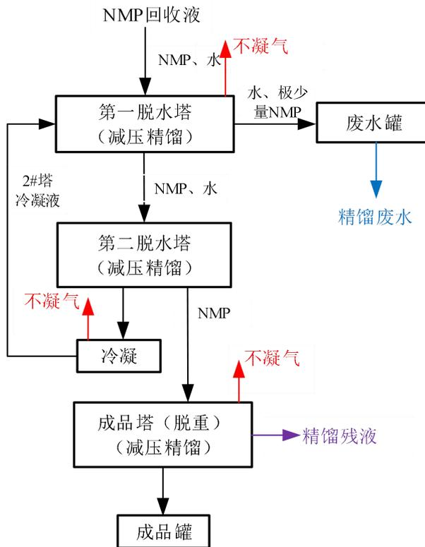
图 2-6 NMP 精馏工艺流程图
