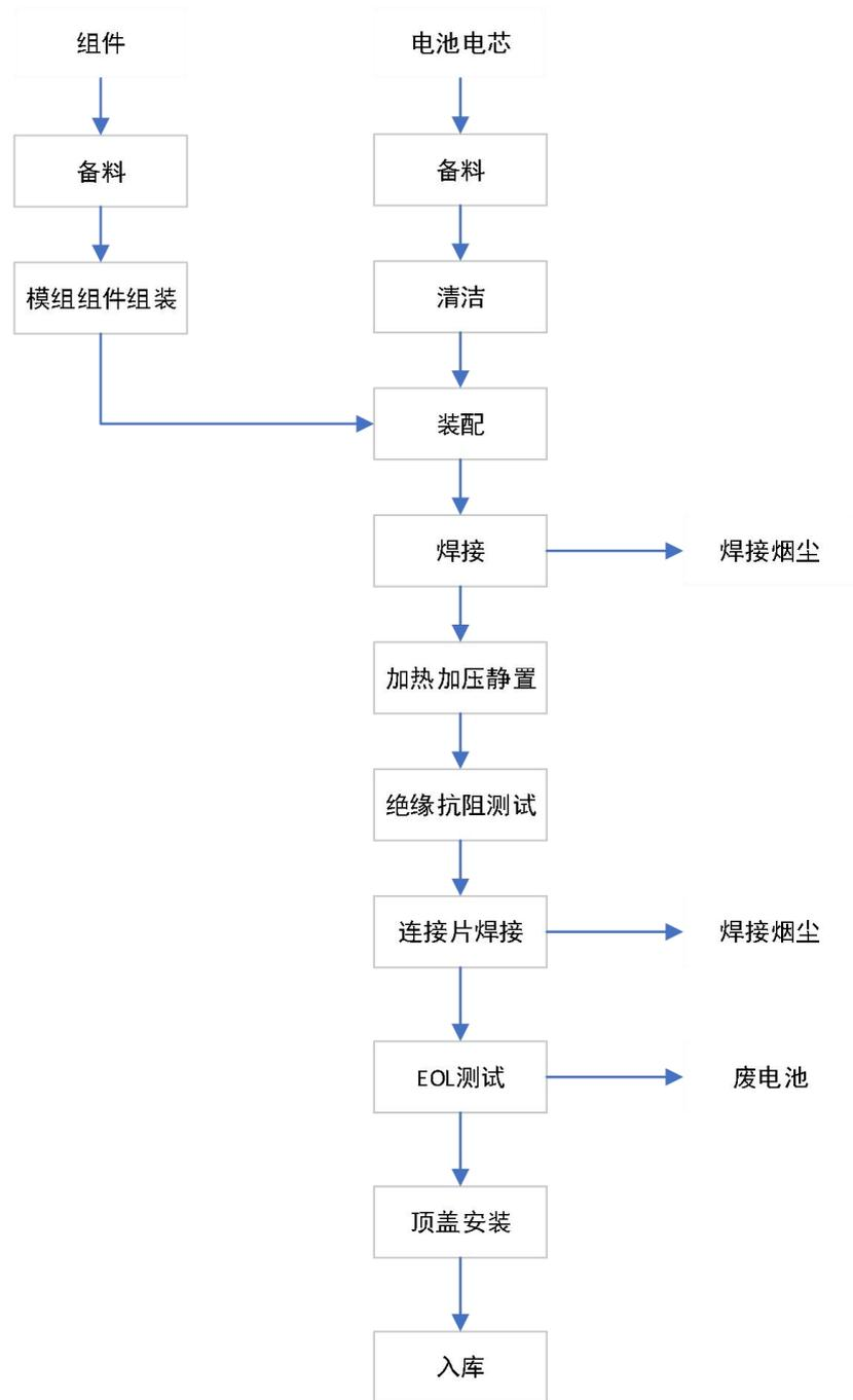
图 2-8 现有项目电池模组生产工艺流程图
