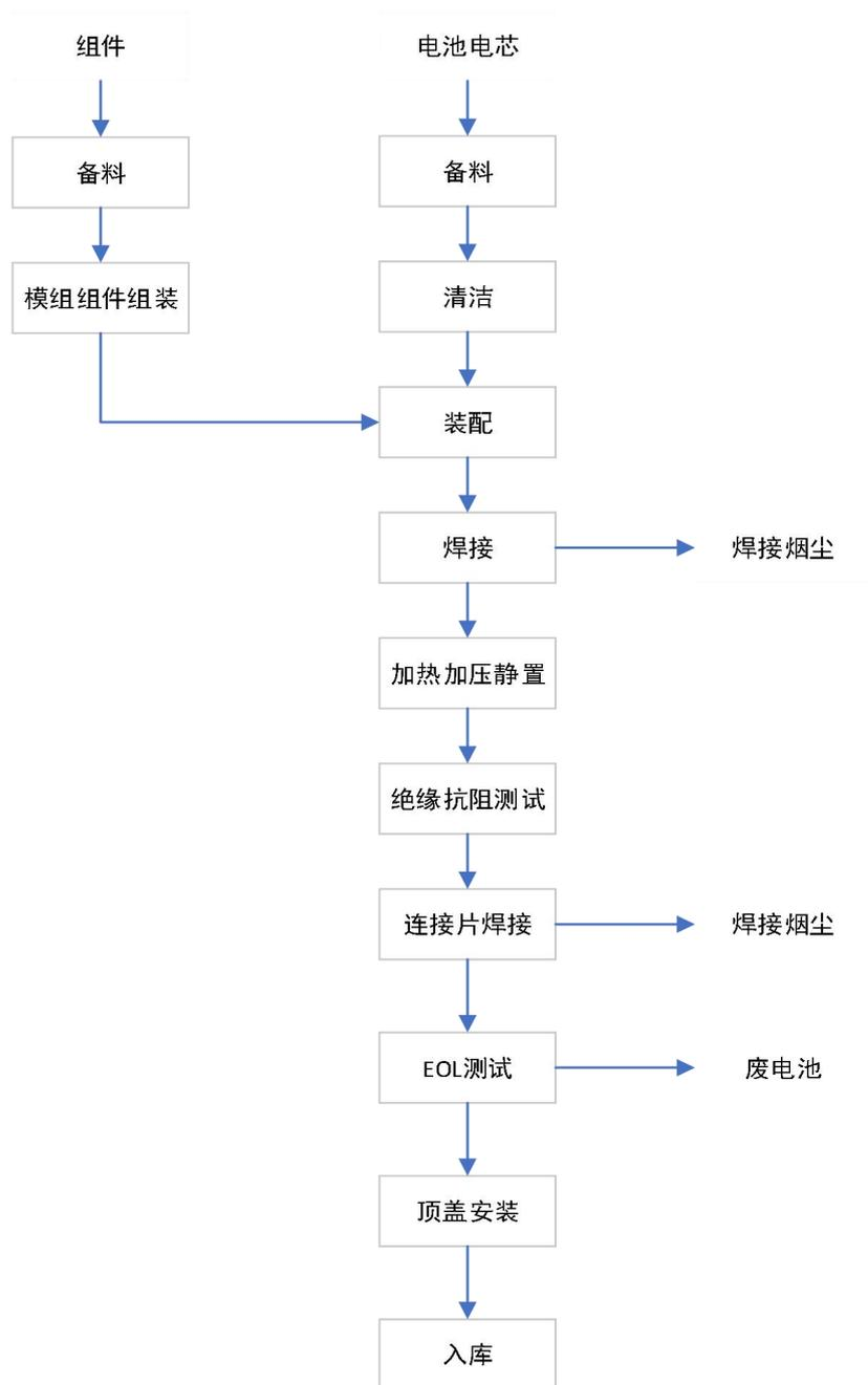
图 2-5 电池模组生产工艺流程图
