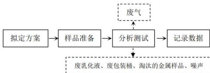
图 2-7 样品结构分析实验流程及产污环节
