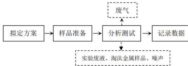
图 2-4 化学反应测试实验流程及产污环节
