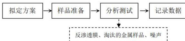
图 2-2 物理性能测试实验流程及产污环节
