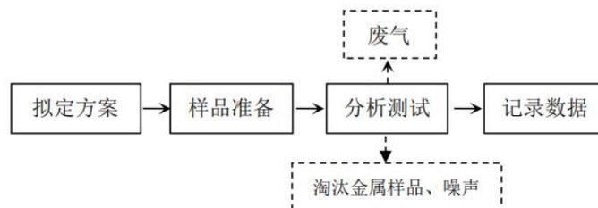
图 2-5 型材试验实验流程及产污环节
