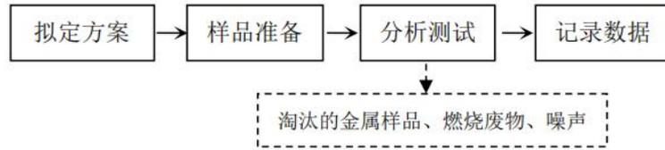
图 2-3 含碳量测试实验流程及产污环节
