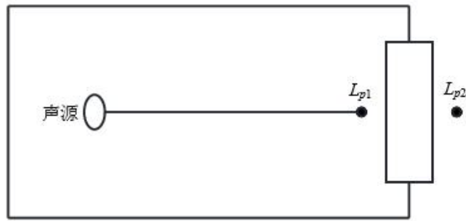
图 4-2 室内声源等效为室外声源图例
