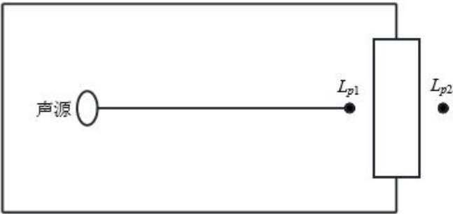
图 4-1 室内声源等效为室外声源图例
