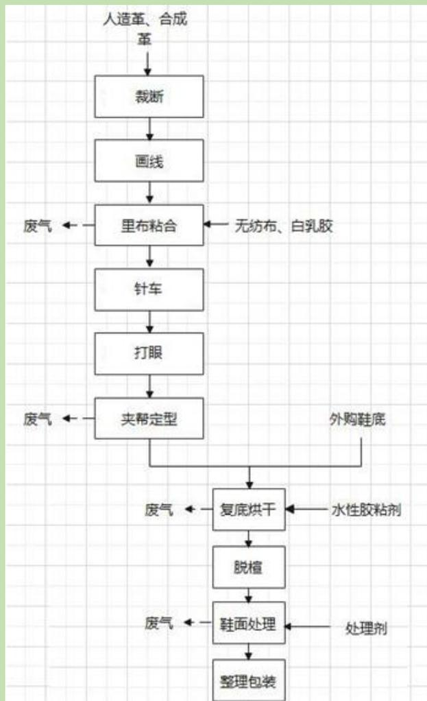
图 2-4 冷粘鞋生产工艺流程及产污环节示意图
