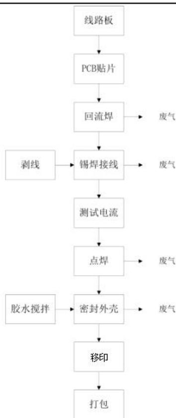
图 2-4 风扇控制器、继电器生产工艺流程图
