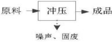
c、压缩机密封垫产污工艺流程图
