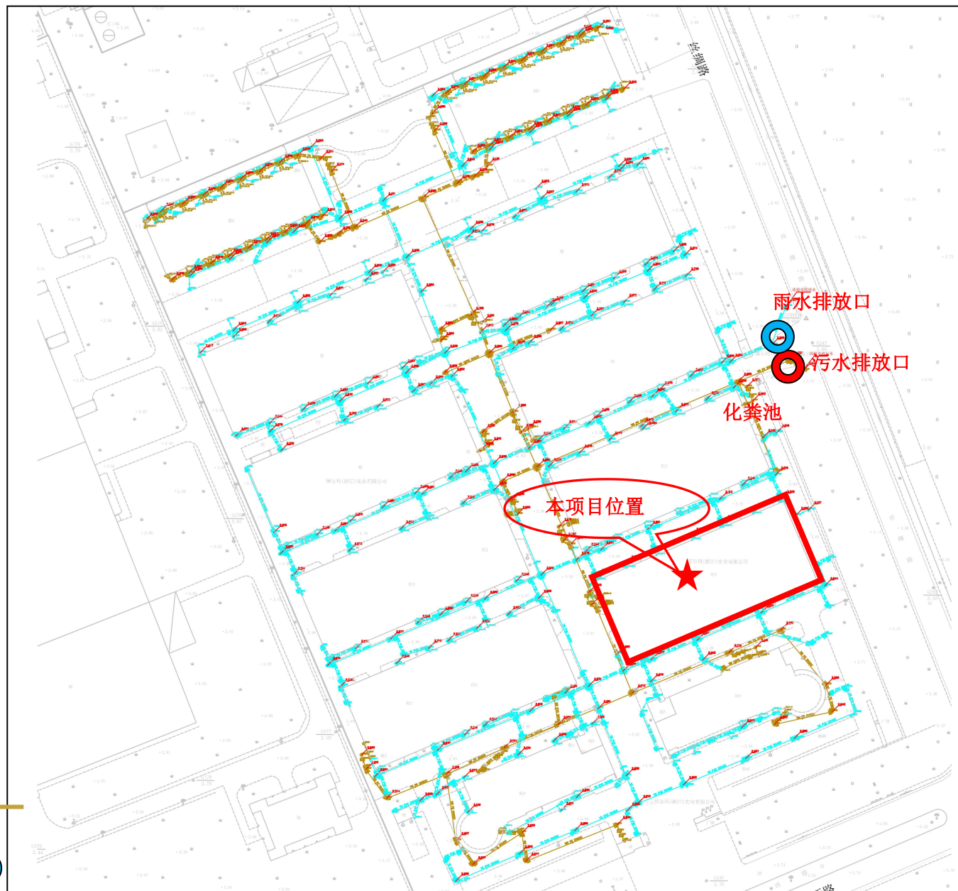
附图6 厂区雨污管网图
