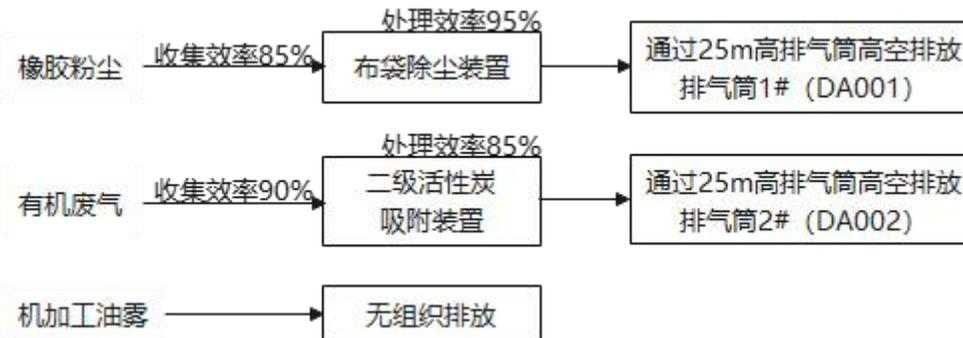
图 3-1 废气处理工艺流程图
