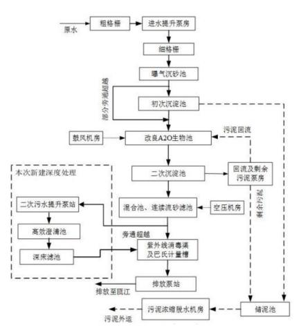
图 4-2 污水处理工艺流程图
