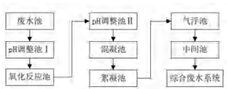
图 7.2-6 高浓度前处理废水处理工艺流程图
