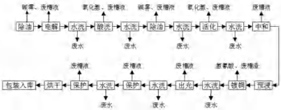
图 3.2-4 MF05 镀铜滚镀线工艺流程图
