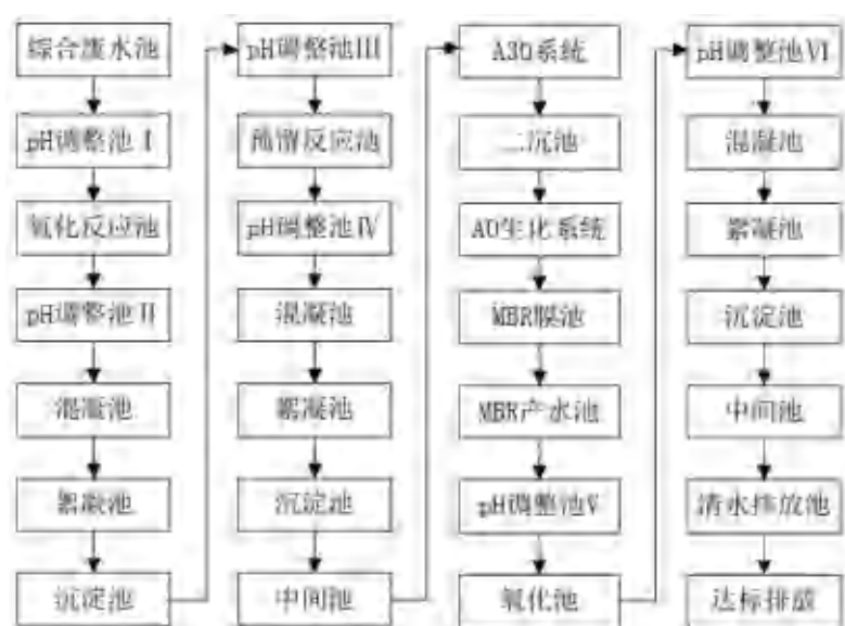
图 5.2-7 综合废水处理工艺流程图
