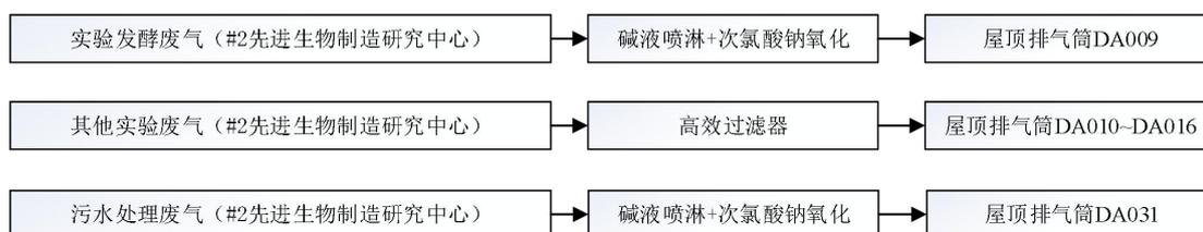
图 4-1 废气处理系统图
